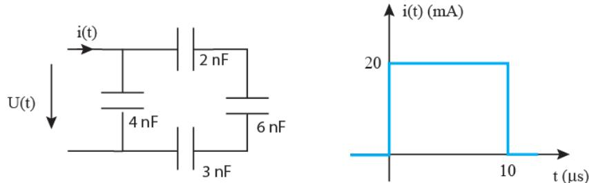
(a) Quelle est la capacité équivalente à l'agencement des 4 condensateurs ?
