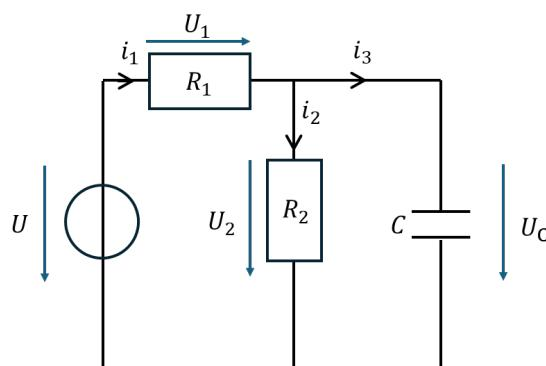
Nous souhaitons déterminer l'évolution de la tension aux bornes du condensateur.
