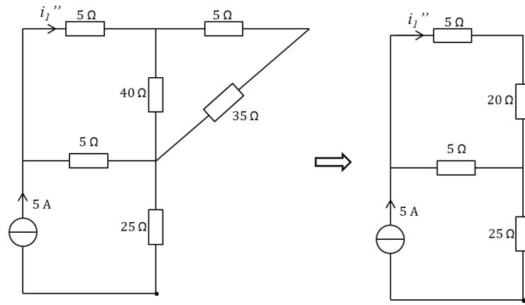
$$\text{Par le diviseur de courant : } i_1'' = \frac{5}{5+5+20} 5 = \frac{25}{30} \text{ A}$$
