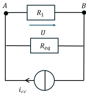
En remarquant que  $R_1$  et  $R_{eq}$  sont en parallèle, on peut appliquer la loi d'Ohm sur la résistance équivalente :
