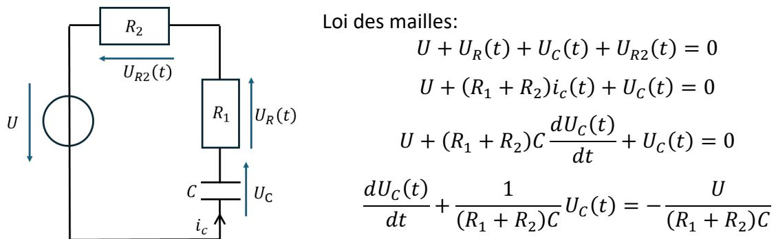
La constante de temps pour ce circuit est donnée par  $\tau_{c1} = (R_1 + R_2)C = 150$  ps
